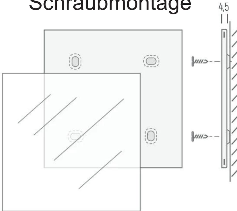
Die Tür- und Infoschilder werden mittels Flachkopfschrauben durch die Schildrückplatte an der Wand montiert.
