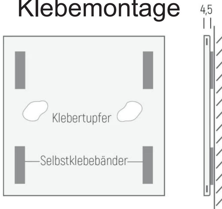
An der Rückseite des Schildes sind Selbstklebebänder angebracht, je nach Schildgröße zwei bis vier Klebertupfer anbringen. Das Schild positionieren und an die Wand pressen, der Pressdruck ist maßgeblich für die Haltbarkeit verantwortlich.
